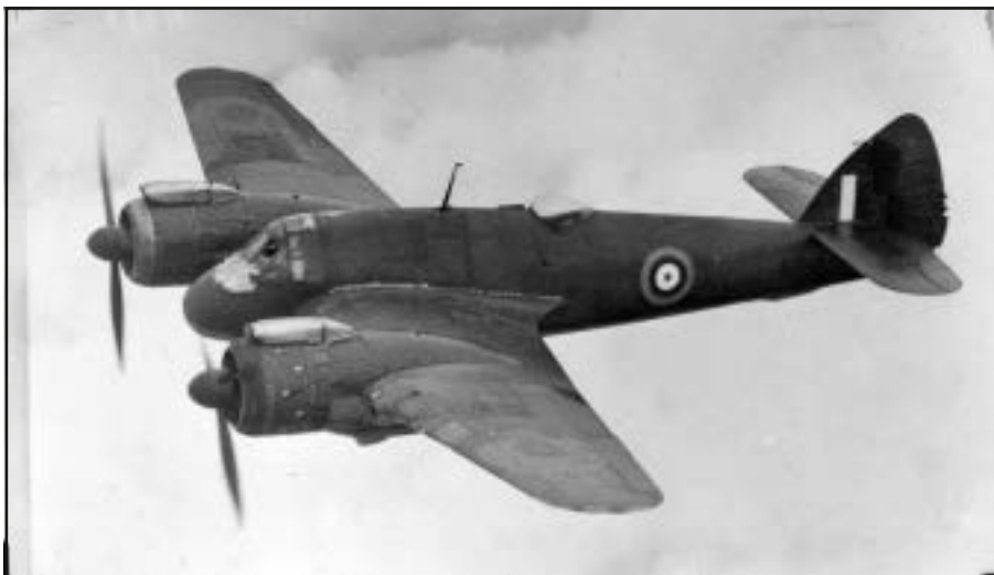
Un bimotore britannico Bristol Beaufigther: il suo armamento di quattro canoni da 20 mm e quattro mitragliatrici da 7,7, oltre a quello di caduta che poteva comprendere bombe, razzi o siluri, gli avevano fatto meritare il soprannome di "Wispering Death", morte sussurrante.
